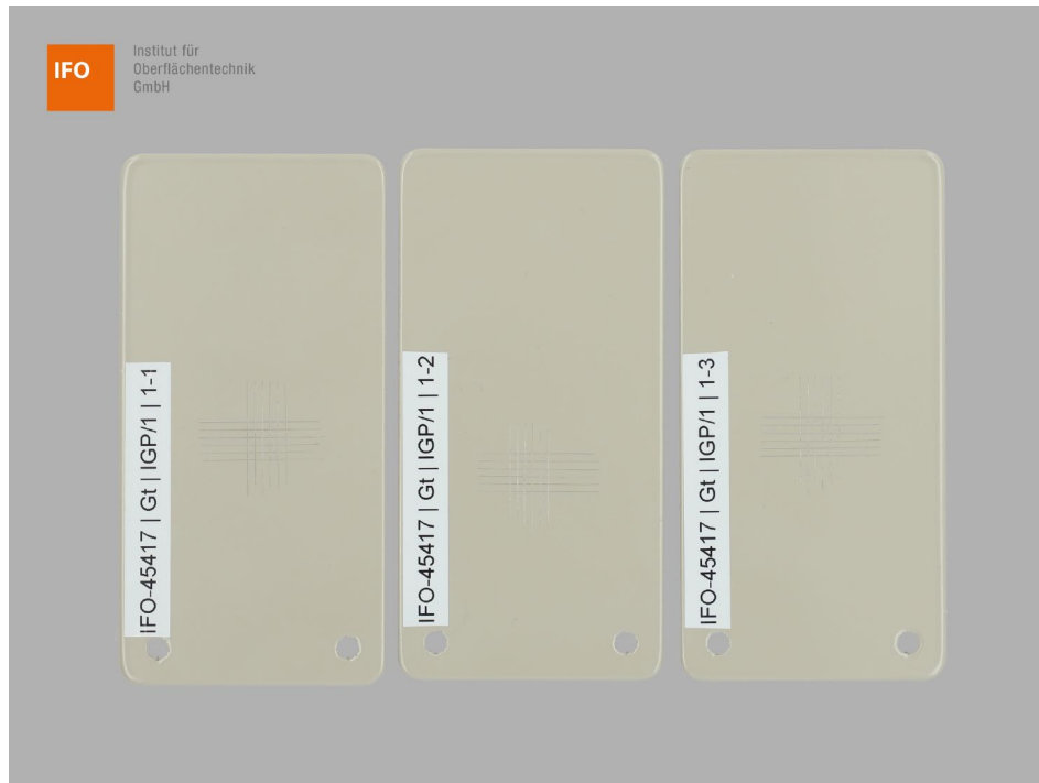
Abbildung 1 – Proben 1-3 der Variante 1 nach der Gitterschnittprüfung
