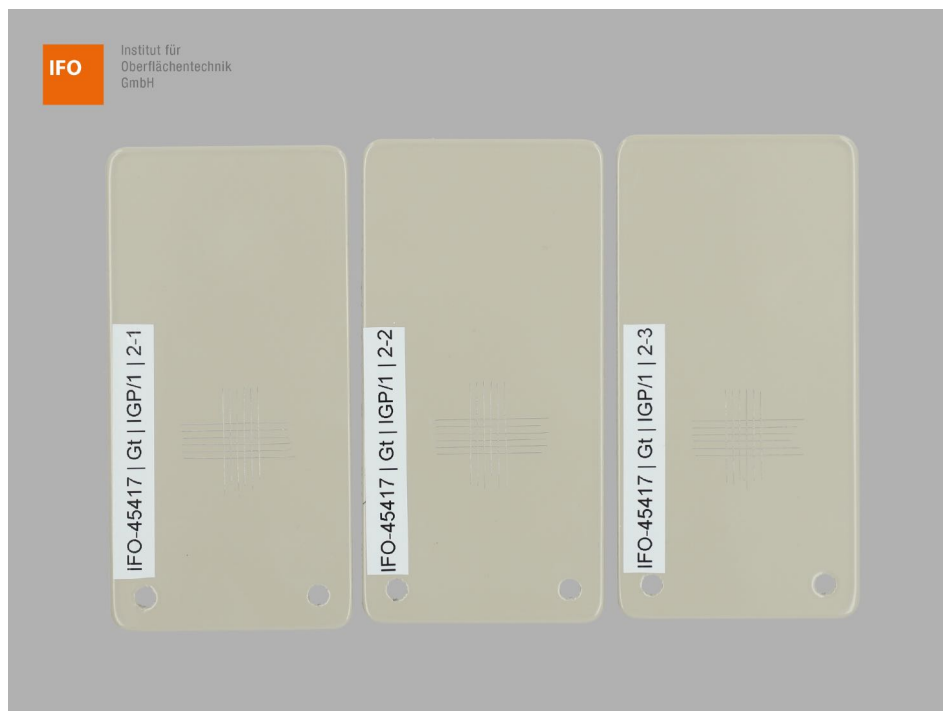
Abbildung 2 – Proben 1-3 der Variante 2 nach der Gitterschnittprüfung
