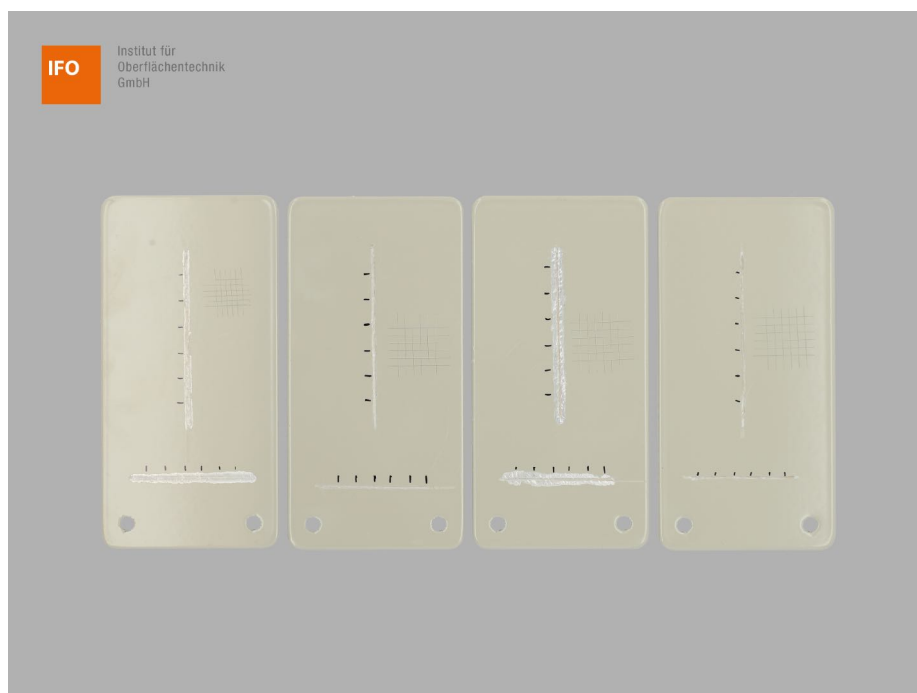
Abbildung 6 – Proben 4 der Varianten 1, 2, 3 und 4 nach 720 h NSS-Prüfung, 24 h Konditionierung (NK 23/50) und Gitterschnittprüfung
