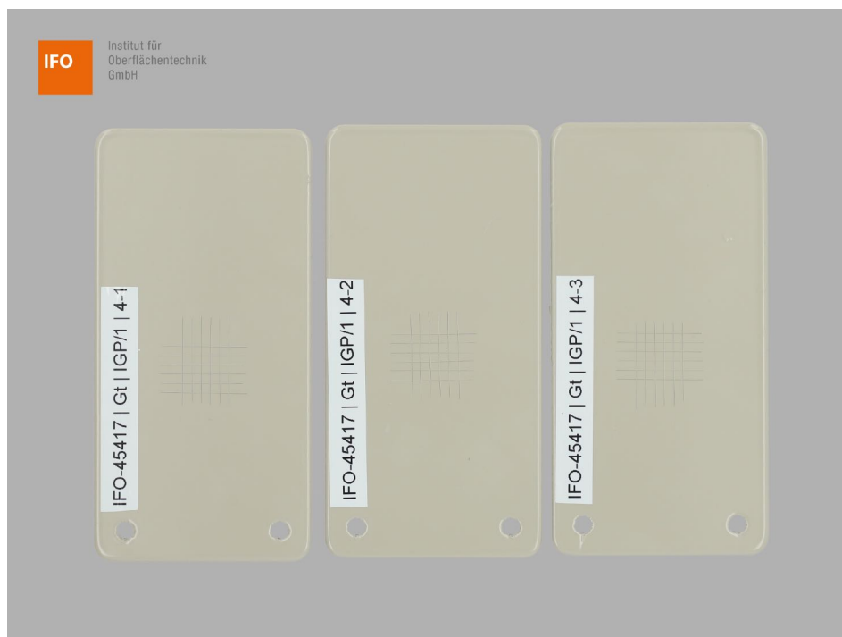
Abbildung 4 – Proben 1-3 der Variante 4 nach der Gitterschnittprüfung
