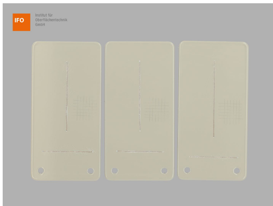
Abbildung 10 – Proben 1-3 der Variante 4 nach 1440 h NSS-Prüfung, 24 h Konditionierung (NK 23/50) und Gitterschnittprüfung
