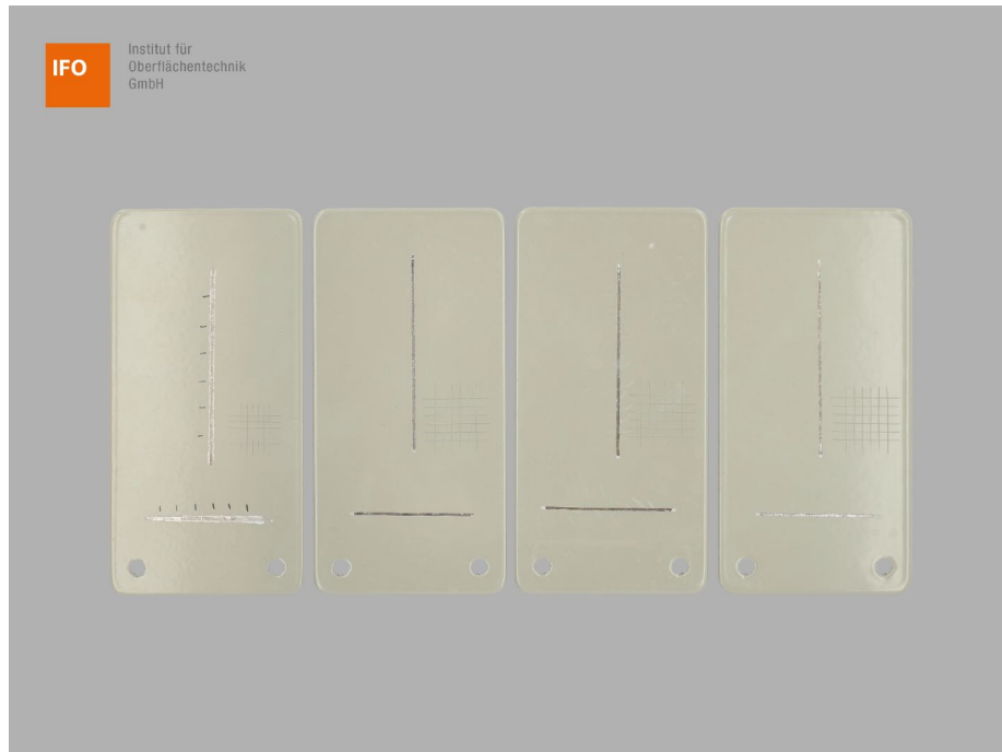
Abbildung 11 – Proben 5 der Varianten 1, 2, 3 und 4 nach 240 h CH-Prüfung, 24 h Konditionierung (NK 23/50) und Gitterschnittprüfung
