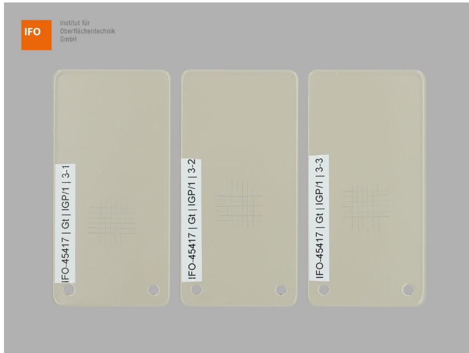
Abbildung 3 – Proben 1-3 der Variante 3 nach der Gitterschnittprüfung
