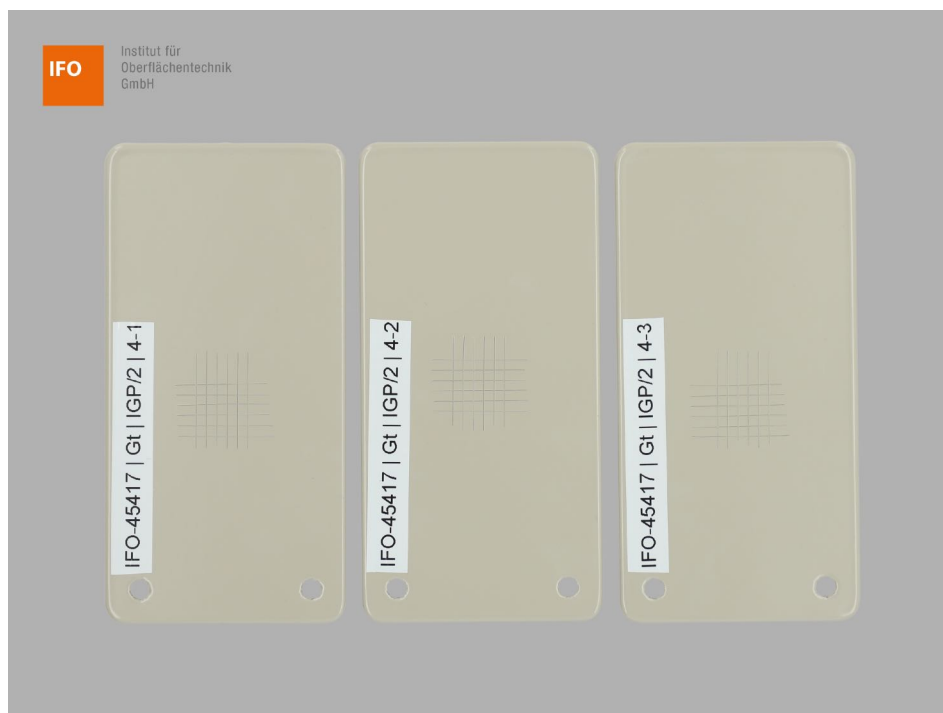
Abbildung 4 – Proben 1-3 der Variante 4 nach der Gitterschnittprüfung
