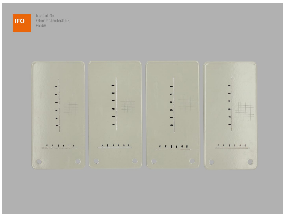
Abbildung 12 – Proben 4 der Varianten 1, 2, 3 und 4 nach 480 h CH-Prüfung, 24 h Konditionierung (NK 23/50) und Gitterschnittprüfung
