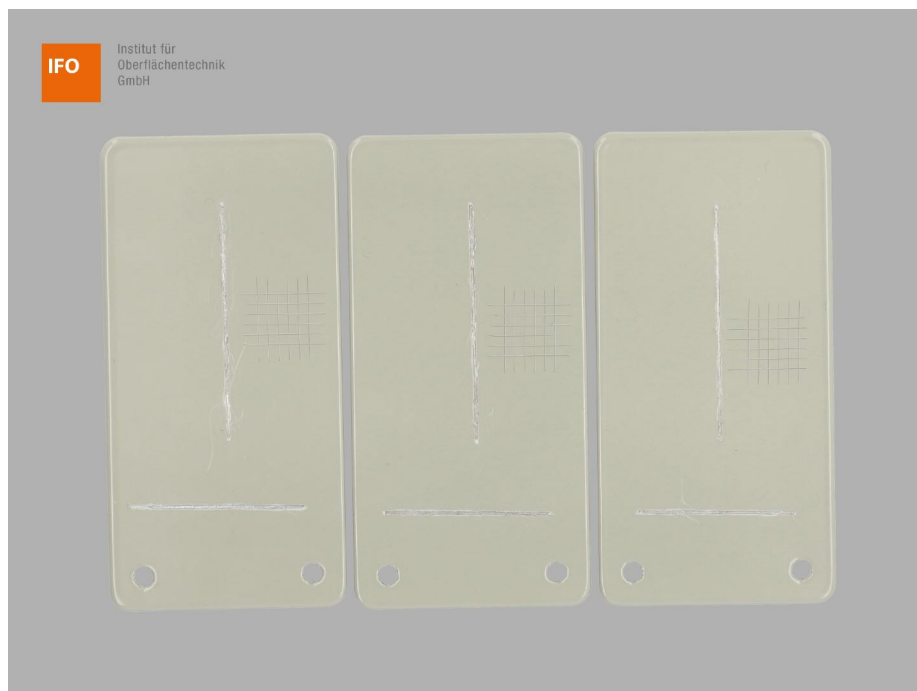
Abbildung 16 – Proben 1-3 der Variante 4 nach 720 h CH-Prüfung, 24 h Konditionierung (NK 23/50) und Gitterschnittprüfung
