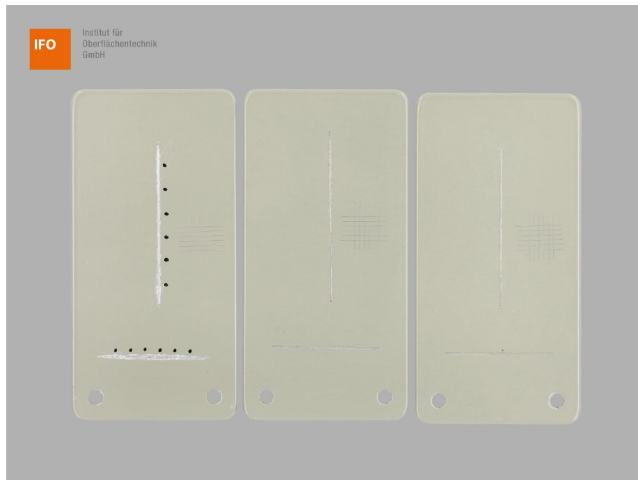
Abbildung 13 – Proben 1-3 der Variante 1 nach 720 h CH-Prüfung, 24 h Konditionierung (NK 23/50) und Gitterschnittprüfung
