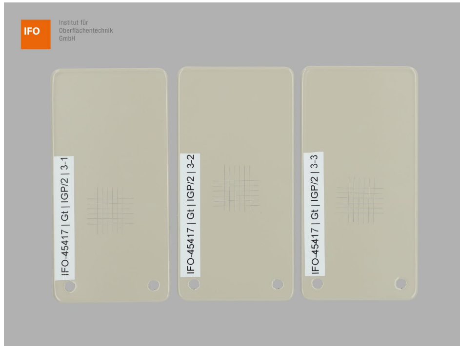
Abbildung 3 – Proben 1-3 der Variante 3 nach der Gitterschnittprüfung
