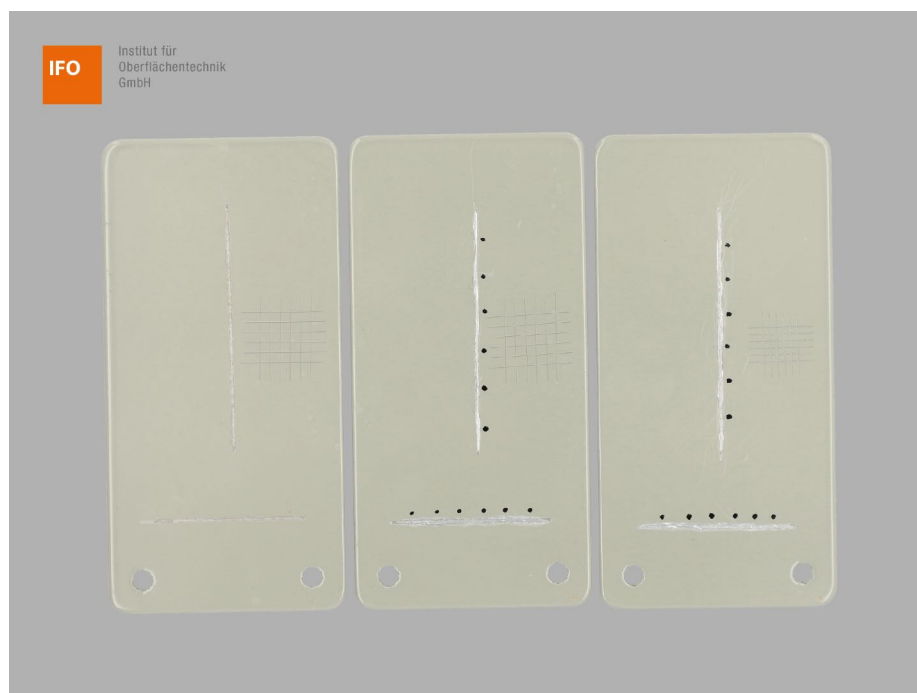
Abbildung 14 – Proben 1-3 der Variante 2 nach 720 h CH-Prüfung, 24 h Konditionierung (NK 23/50) und Gitterschnittprüfung
