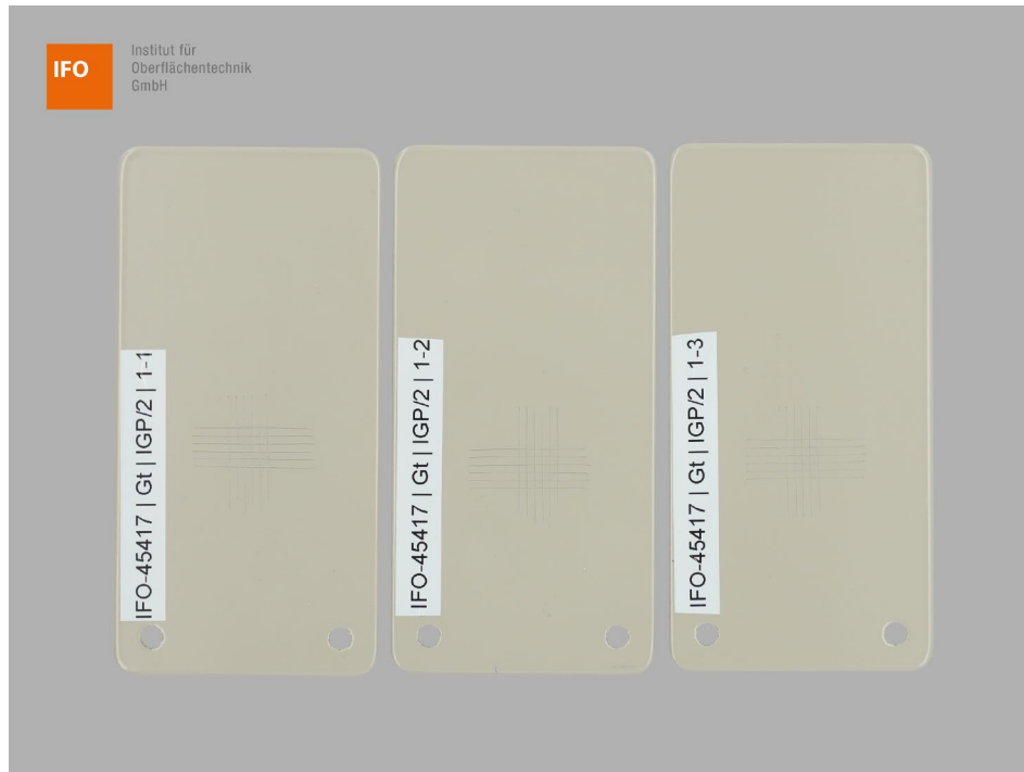
Abbildung 1 – Proben 1-3 der Variante 1 nach der Gitterschnittprüfung
