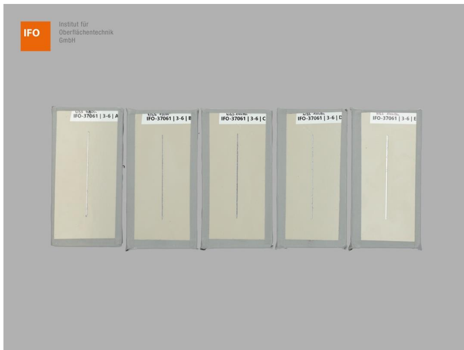
Abbildung 3 – Proben A, B, C, D und E der Gruppe 3 – Variante 6 vor der NSS-Prüfung
