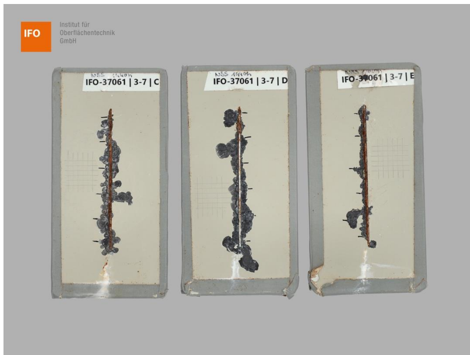
Abbildung 11 – Proben C, D und E der Gruppe 3 – Variante 7 nach 1440 h NSS-Prüfung, 24 h Konditionierung (NK 23/50) und Gitterschnittschnittprüfung
