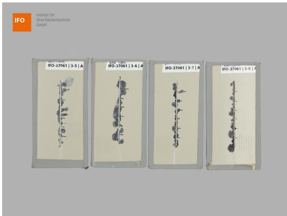
Abbildung 9 – Proben A der Gruppe 3 – Varianten 5, 6, 7, und 8 nach 480 h NSS-Prüfung, 24 h Konditionierung (NK 23/50) und Gitterschnittschnittprüfung
