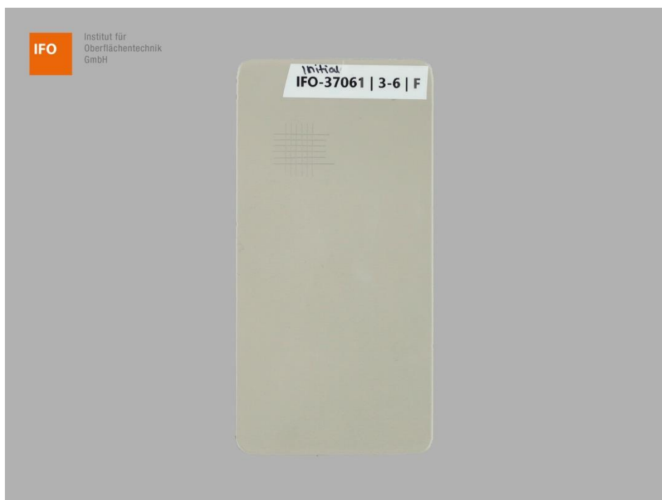
Abbildung 4 – Probe F der Gruppe 3 – Variante 6 nach der Gitterschnittprüfung
