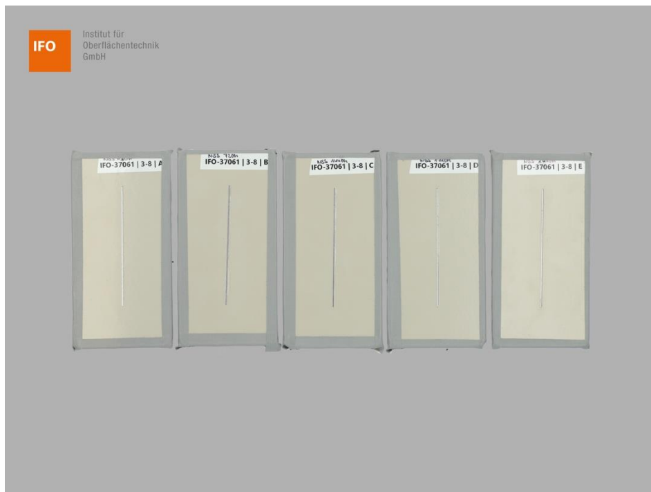
Abbildung 7 – Proben A, B, C, D und E der Gruppe 3 – Variante 8 vor der NSS-Prüfung
