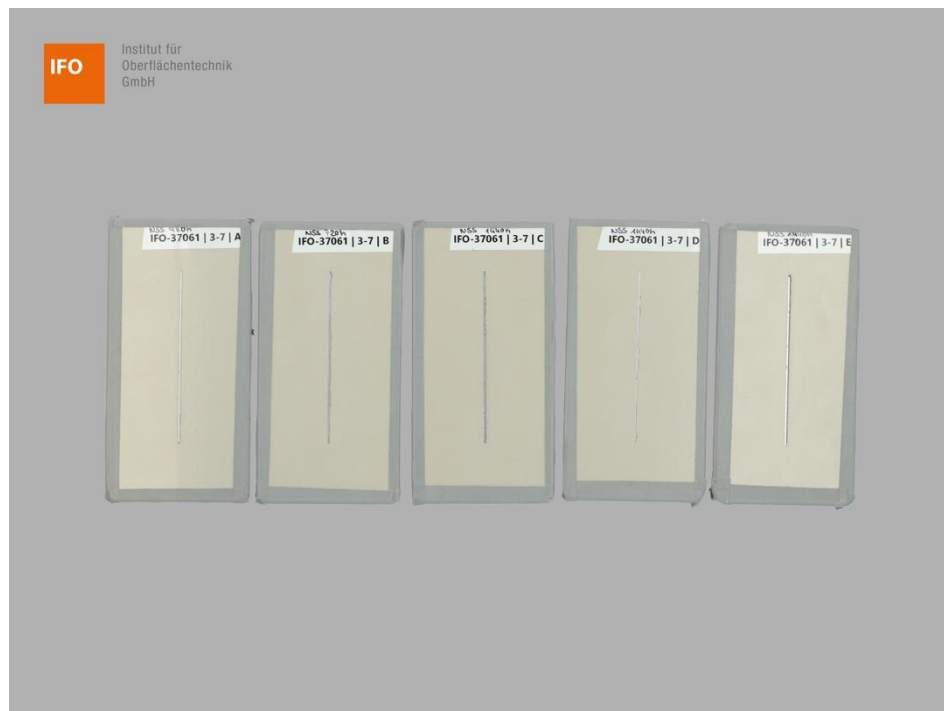
Abbildung 5 – Proben A, B, C, D und E der Gruppe 3 – Variante 7 vor der NSS-Prüfung
