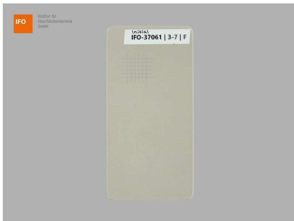
Abbildung 6 – Probe F der Gruppe 3 – Variante 7 nach der Gitterschnittprüfung
