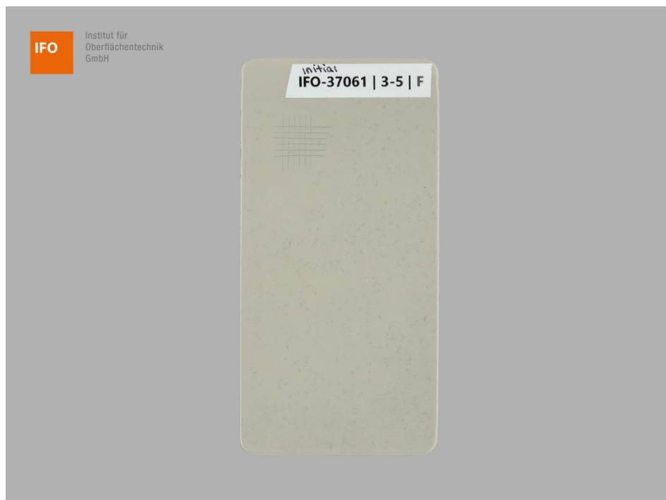
Abbildung 2 – Probe F der Gruppe 3 – Variante 5 nach der Gitterschnittprüfung
