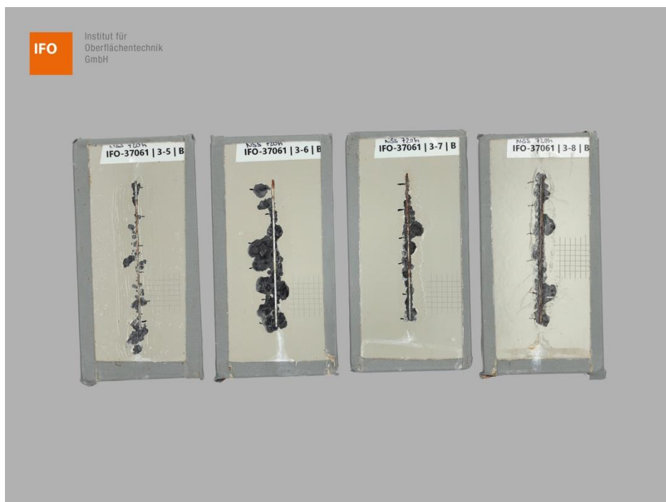
Abbildung 10 – Proben B der Gruppe 3 – Varianten 5, 6, 7, und 8 nach 720 h NSS-Prüfung, 24 h Konditionierung (NK 23/50) und Gitterschnittschnittprüfung
