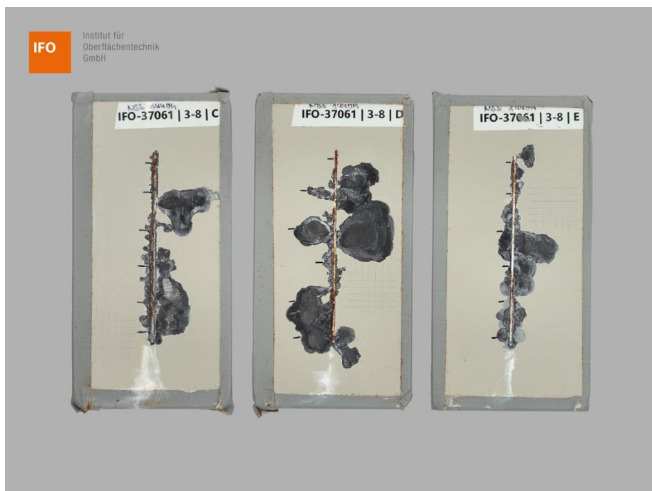
Abbildung 12 – Proben C, D und E der Gruppe 3 – Variante 8 nach 1440 h NSS-Prüfung, 24 h Konditionierung (NK 23/50) und Gitterschnittschnittprüfung
