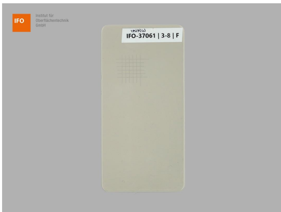
Abbildung 8 – Probe F der Gruppe 3 – Variante 8 nach der Gitterschnittprüfung
