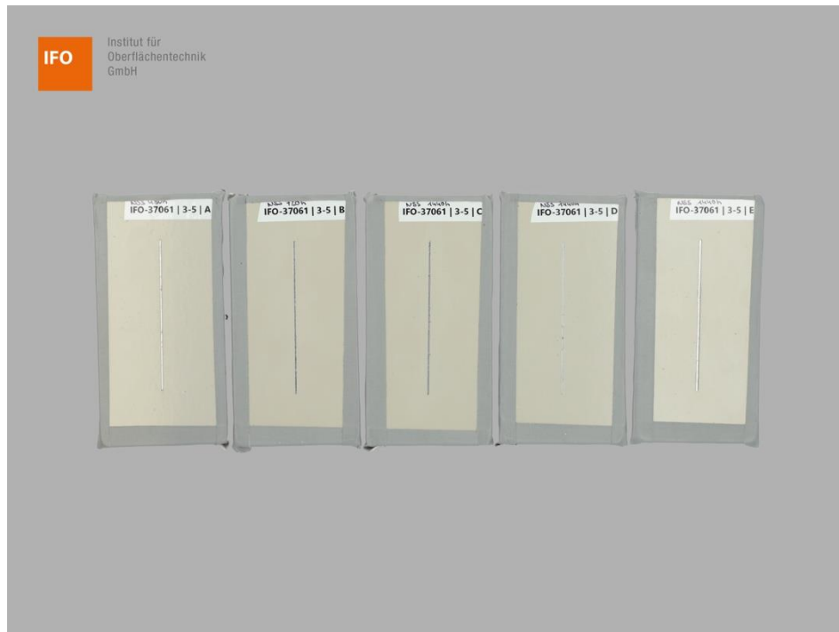
Abbildung 1 – Proben A, B, C, D und E der Gruppe 3 – Variante 5 vor der NSS-Prüfung
