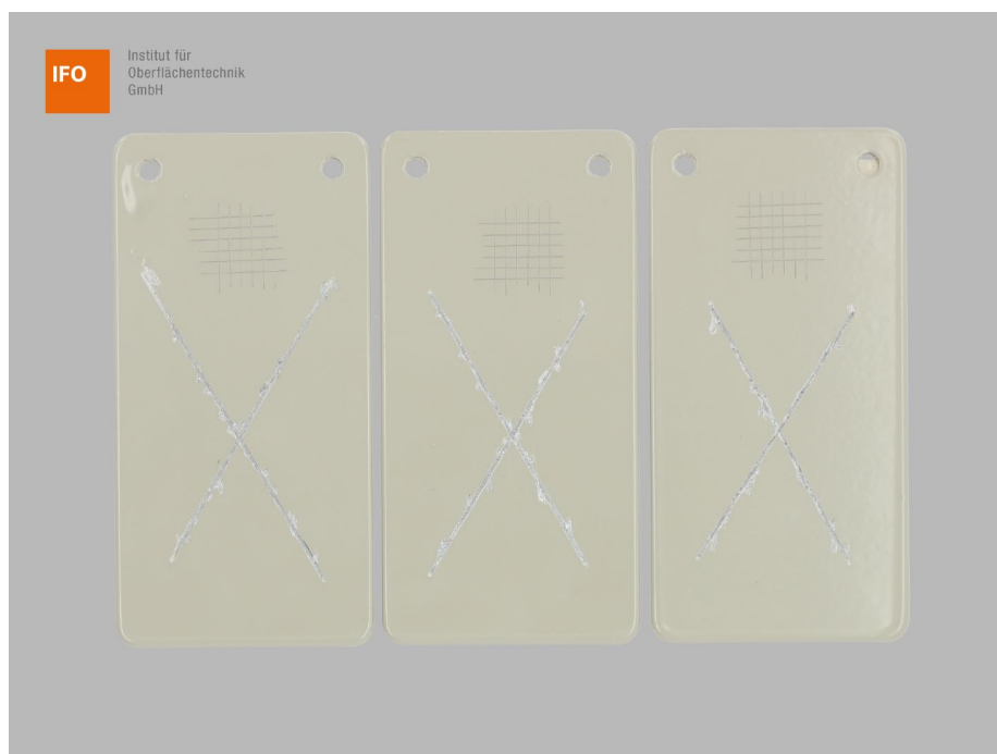
Abbildung 8 – Proben 1000 h 1-3 der Variante 4 nach 1008 h ESS-Prüfung, 24 h Konditionierung (NK 23/50) und Gitterschnittprüfung
