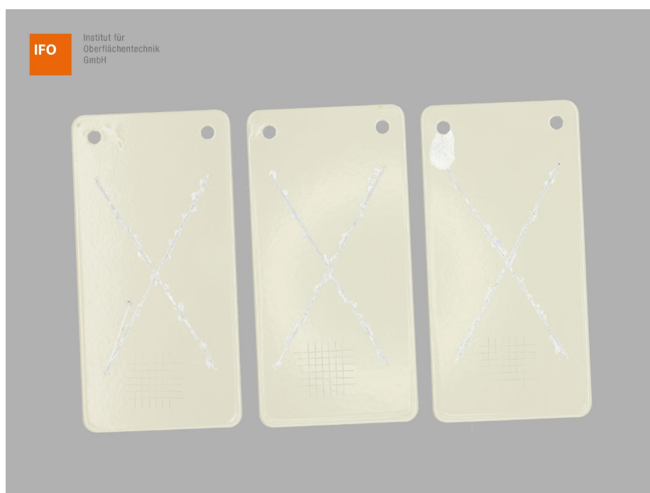
Abbildung 12 – Proben 1500 h 1-3 der Variante 4 nach 1512 h ESS-Prüfung, 24 h Konditionierung (NK 23/50) und Gitterschnittprüfung
