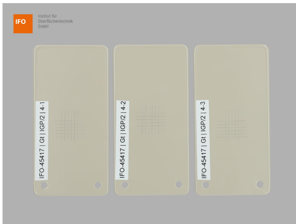
Abbildung 4 – Proben 1-3 der Variante 4 nach der Gitterschnittprüfung
