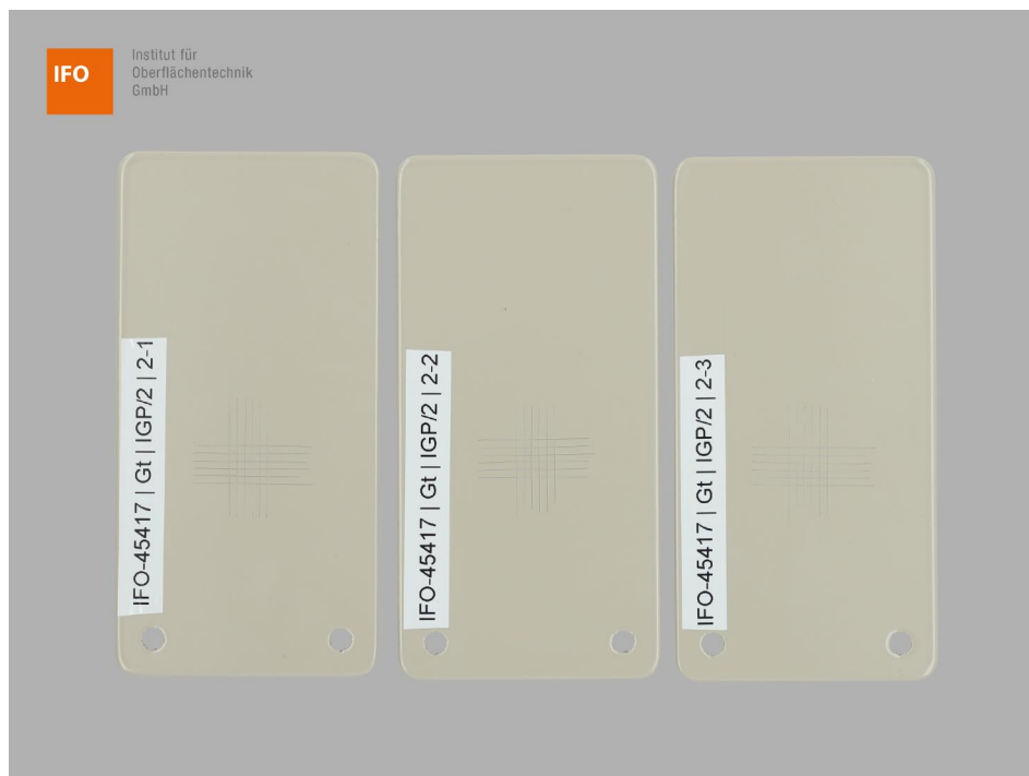
Abbildung 2 – Proben 1-3 der Variante 2 nach der Gitterschnittprüfung
