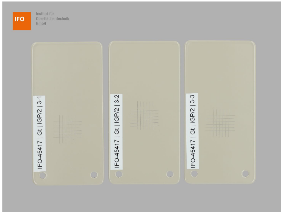
Abbildung 3 – Proben 1-3 der Variante 3 nach der Gitterschnittprüfung
