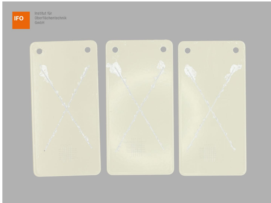
Abbildung 9 – Proben 1500 h 1-3 der Variante 1 nach 1512 h ESS-Prüfung, 24 h Konditionierung (NK 23/50) und Gitterschnittprüfung
