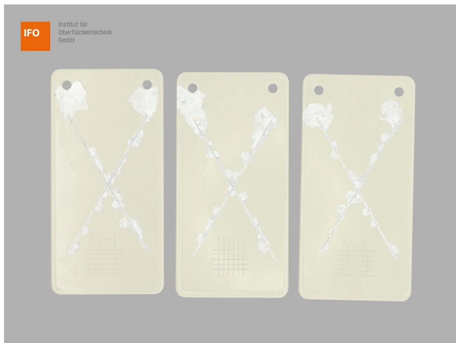
Abbildung 11 – Proben 1500 h 1-3 der Variante 3 nach 1512 h ESS-Prüfung, 24 h Konditionierung (NK 23/50) und Gitterschnittprüfung
