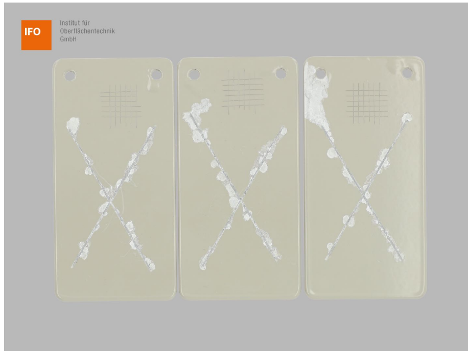
Abbildung 7 – Proben 1000 h 1-3 der Variante 3 nach 1008 h ESS-Prüfung, 24 h Konditionierung (NK 23/50) und Gitterschnittprüfung
