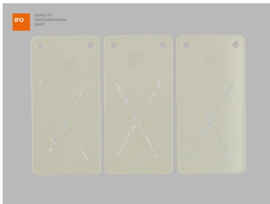
Abbildung 6 – Proben 1000 h 1-3 der Variante 2 nach 1008 h ESS-Prüfung, 24 h Konditionierung (NK 23/50) und Gitterschnittprüfung
