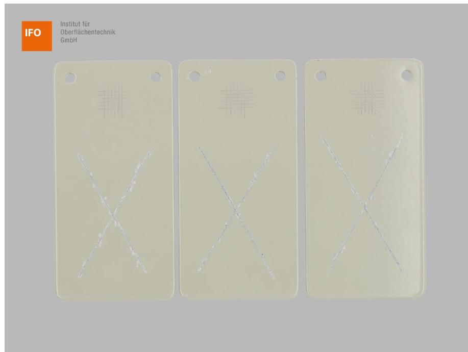
Abbildung 5 – Proben 1000 h 1-3 der Variante 1 nach 1008 h ESS-Prüfung, 24 h Konditionierung (NK 23/50) und Gitterschnittprüfung
