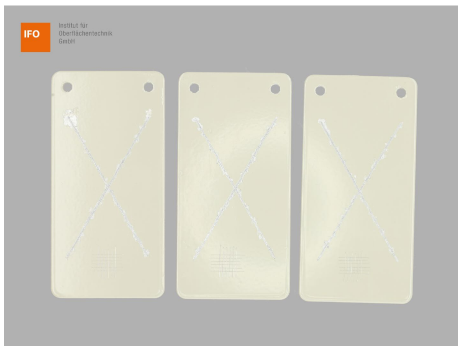
Abbildung 10 – Proben 1500 h 1-3 der Variante 2 nach 1512 h ESS-Prüfung, 24 h Konditionierung (NK 23/50) und Gitterschnittprüfung
