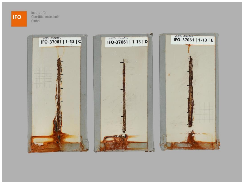
Abbildung 13 – Proben C, D und E der Gruppe 1 – Variante 13 nach 1440 h NSS-Prüfung, 24 h Konditionierung (NK 23/50) und Gitterschnittschnittprüfung
