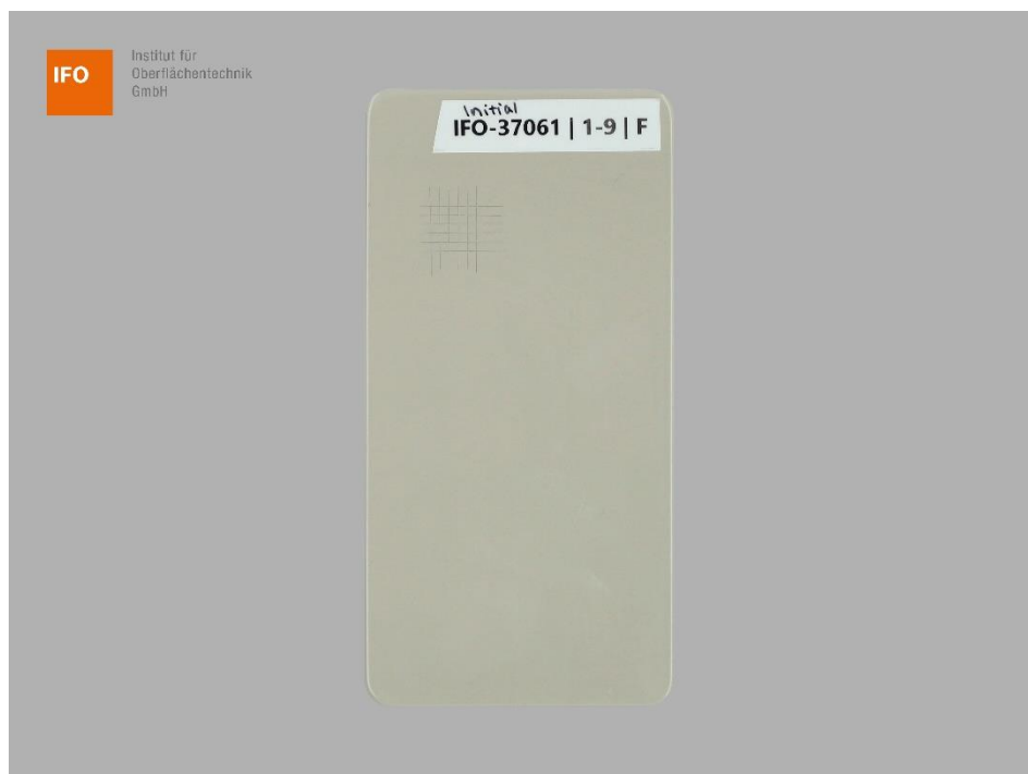
Abbildung 2 – Probe F der Gruppe 1 – Variante 9 nach der Gitterschnittprüfung
