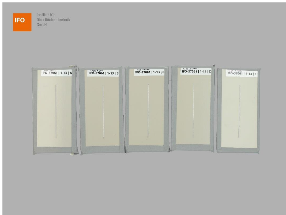
Abbildung 9 – Proben A, B, C, D und E der Gruppe 1 – Variante 13 vor der NSS-Prüfung
