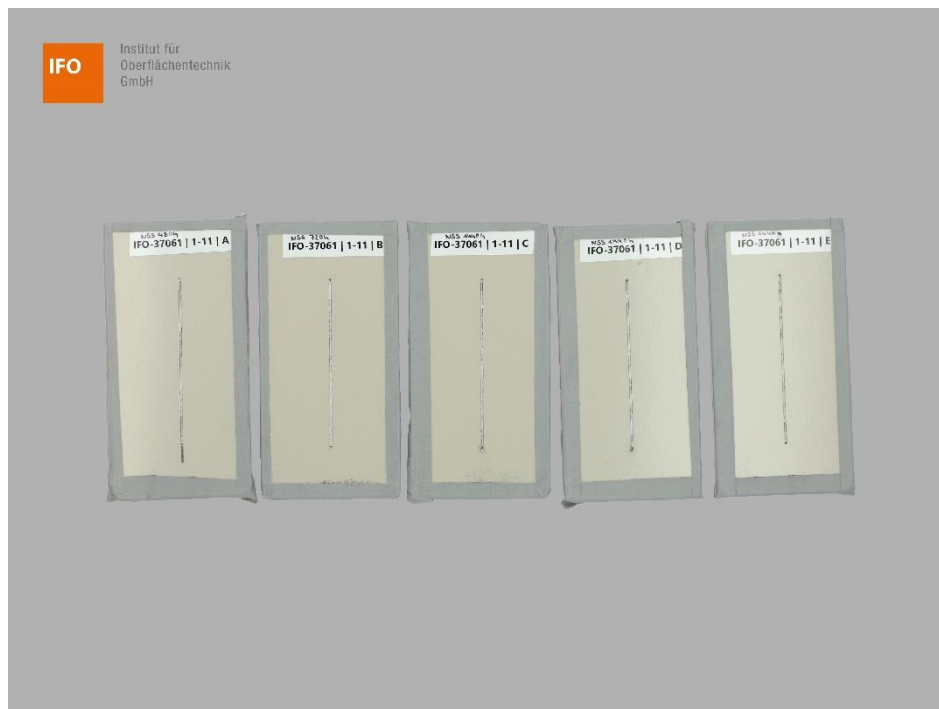
Abbildung 5 – Proben A, B, C, D und E der Gruppe 1 – Variante 11 vor der NSS-Prüfung
