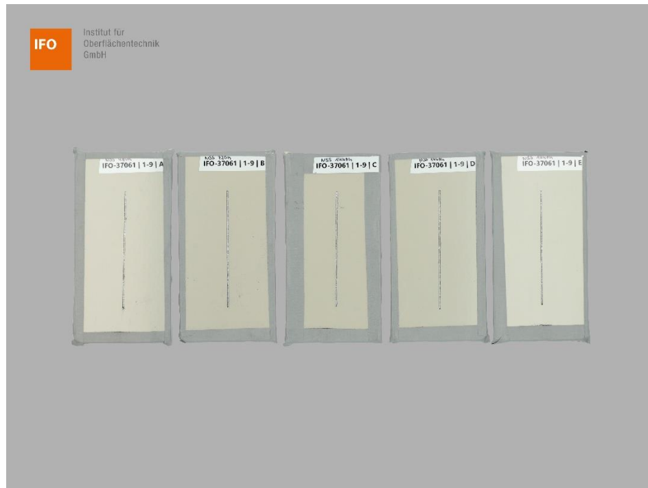
Abbildung 1 – Proben A, B, C, D und E der Gruppe 1 – Variante 9 vor der NSS-Prüfung
