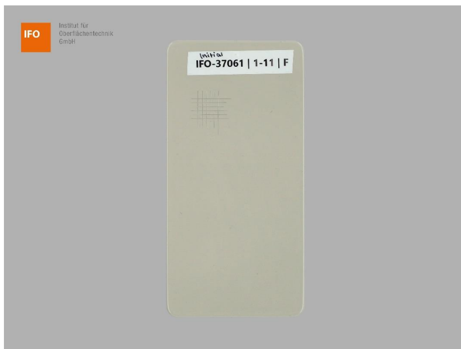
Abbildung 6 – Probe F der Gruppe 1 – Variante 11 nach der Gitterschnittprüfung
