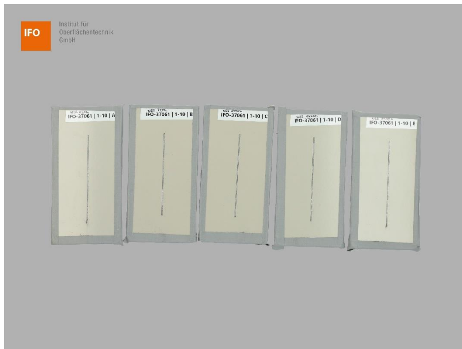
Abbildung 3 – Proben A, B, C, D und E der Gruppe 1 – Variante 10 vor der NSS-Prüfung
