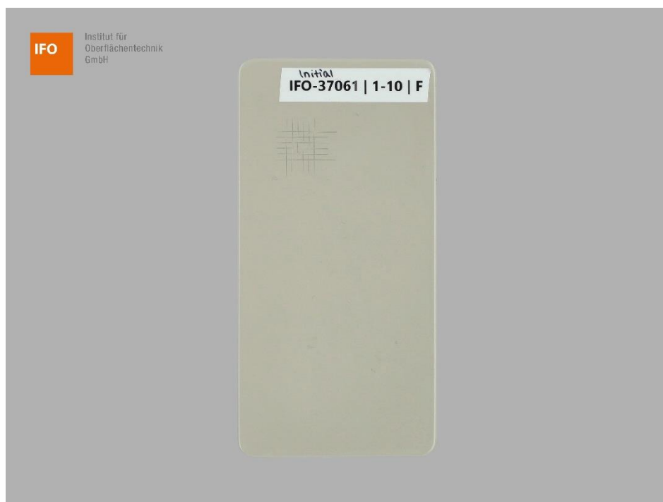
Abbildung 4 – Probe F der Gruppe 1 – Variante 10 nach der Gitterschnittprüfung
