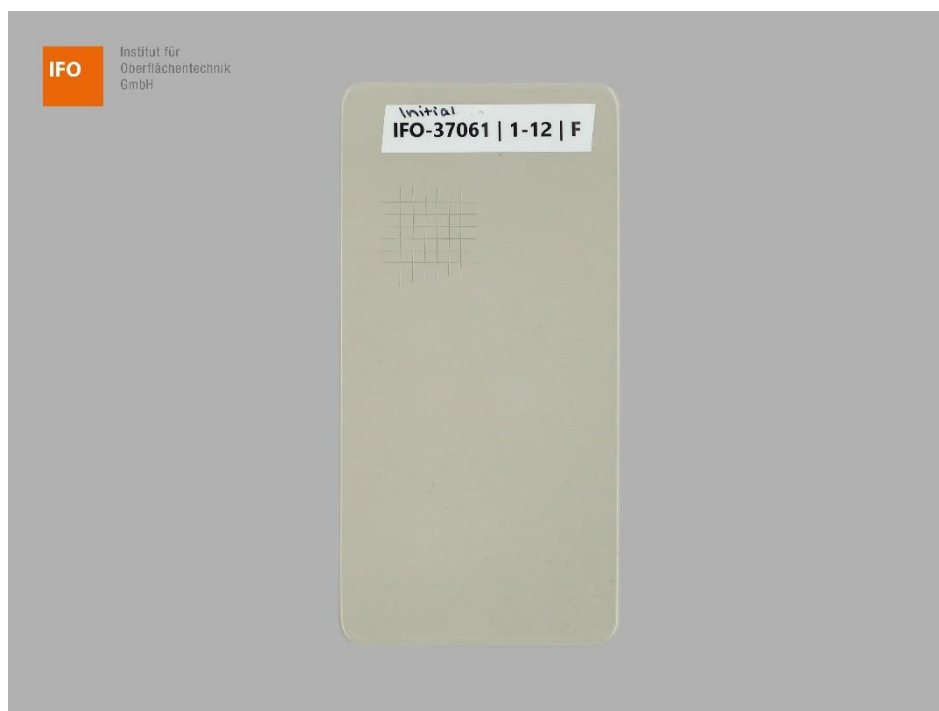
Abbildung 8 – Probe F der Gruppe 1 – Variante 12 nach der Gitterschnittprüfung
