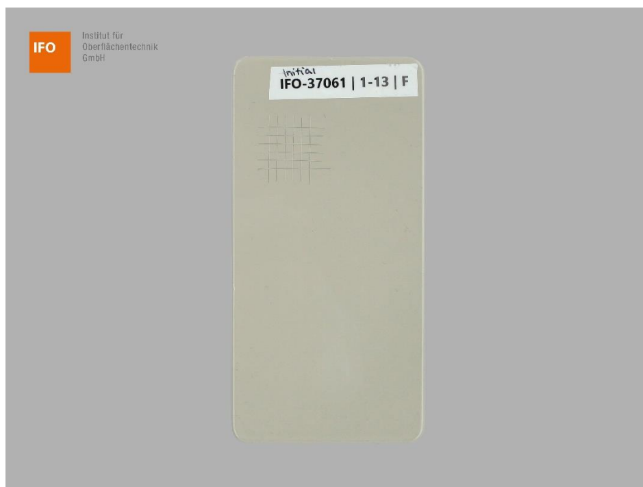
Abbildung 10 – Probe F der Gruppe 1 – Variante 13 nach der Gitterschnittprüfung
