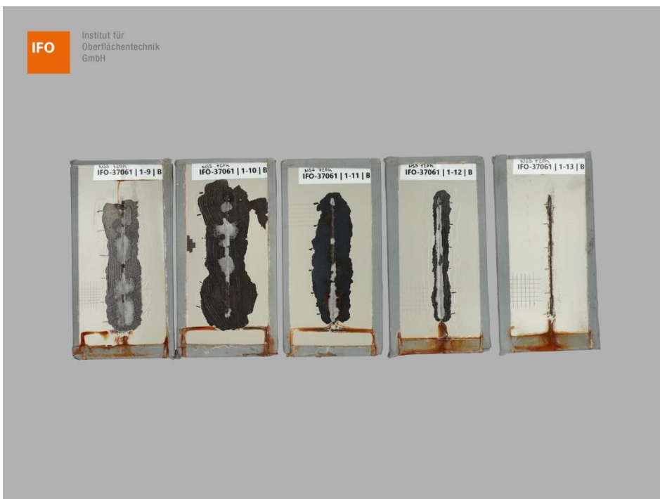
Abbildung 12 – Proben B der Gruppe 1 – Varianten 9, 10, 11, 12 und 13 nach 720 h NSS-Prüfung, 24 h Konditionierung (NK 23/50) und Gitterschnittschnittprüfung
