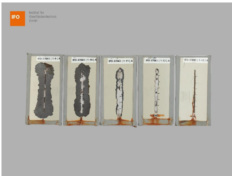
Abbildung 11 – Proben A der Gruppe 1 – Varianten 9, 10, 11, 12 und 13 nach 480 h NSS-Prüfung, 24 h Konditionierung (NK 23/50) und Gitterschnittschnittprüfung
