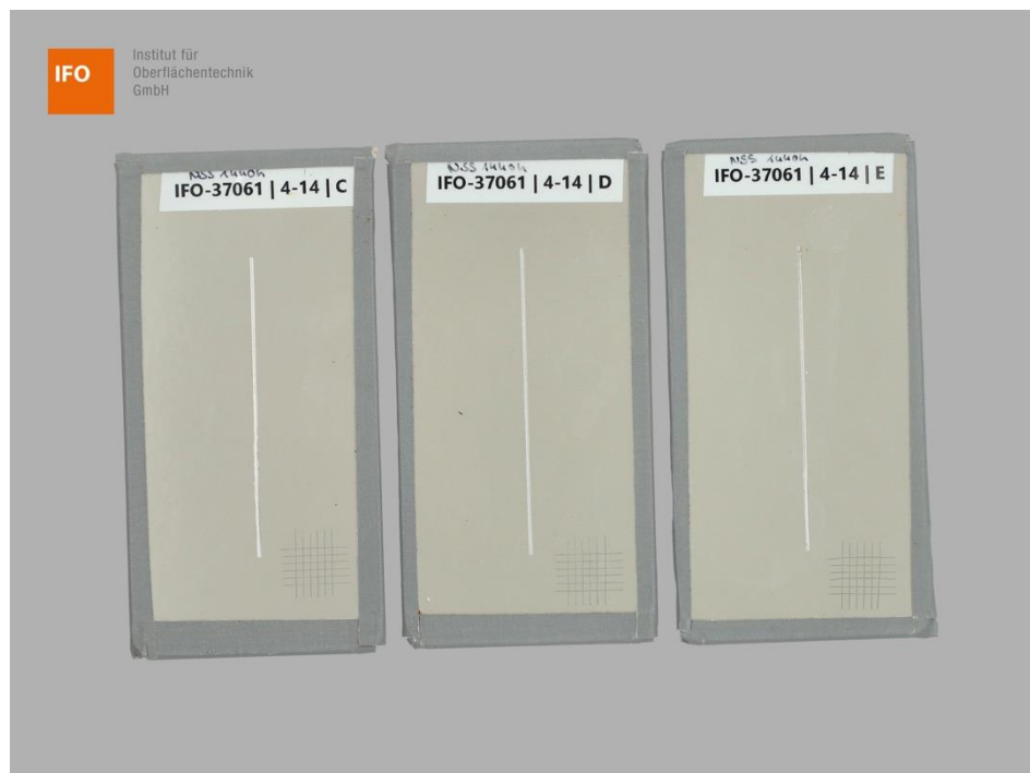
Abbildung 10 – Proben C, D und E der Gruppe 4 – Variante 14 nach 1440 h NSS-Prüfung, 24 h Konditionierung (NK 23/50) und Gitterschnittschnittprüfung
