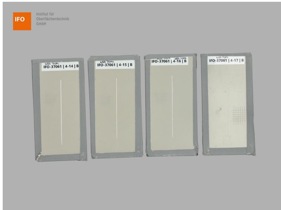
Abbildung 9 – Proben B der Gruppe 4 – Varianten 14, 15, 16 und 17 nach 720 h NSS-Prüfung, 24 h Konditionierung (NK 23/50) und Gitterschnittschnittprüfung
