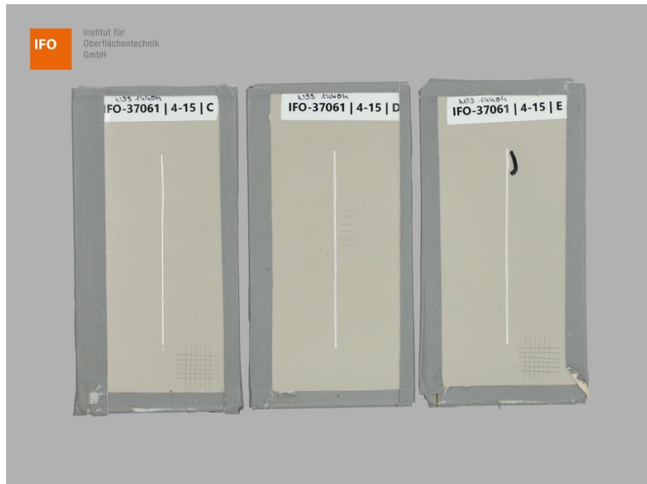
Abbildung 11 – Proben C, D und E der Gruppe 4 – Variante 15 nach 1440 h NSS-Prüfung, 24 h Konditionierung (NK 23/50) und Gitterschnittschnittprüfung
