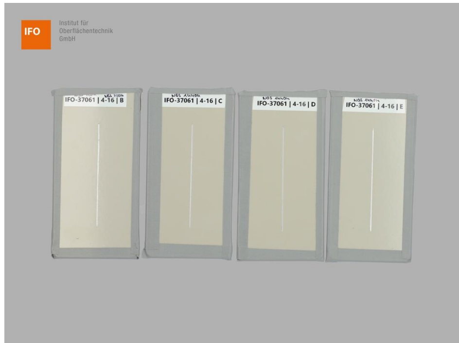
Abbildung 5 – Proben B, C, D und E der Gruppe 4 – Variante 16 vor der NSS-Prüfung
