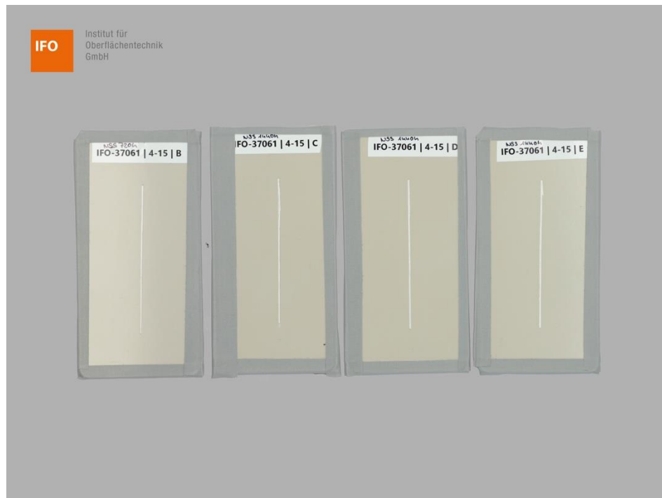
Abbildung 3 – Proben B, C, D und E der Gruppe 4 – Variante 15 vor der NSS-Prüfung
