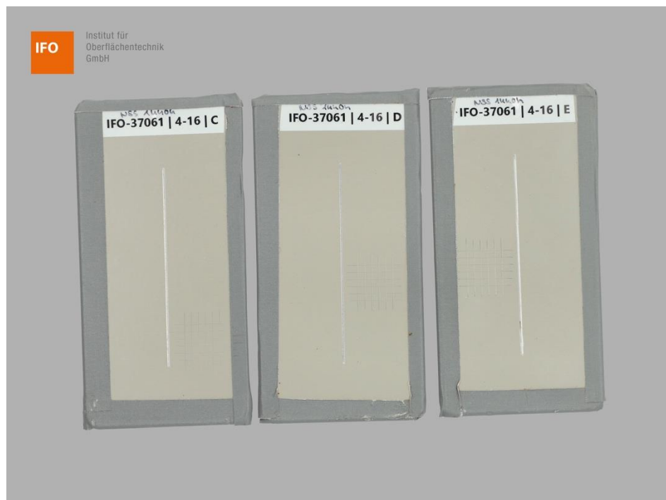
Abbildung 12 – Proben C, D und E der Gruppe 4 – Variante 16 nach 1440 h NSS-Prüfung, 24 h Konditionierung (NK 23/50) und Gitterschnittschnittprüfung
