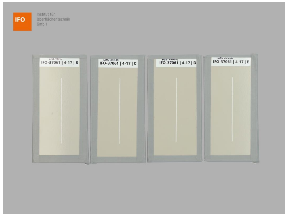
Abbildung 7 – Proben B, C, D und E der Gruppe 4 – Variante 17 vor der NSS-Prüfung
