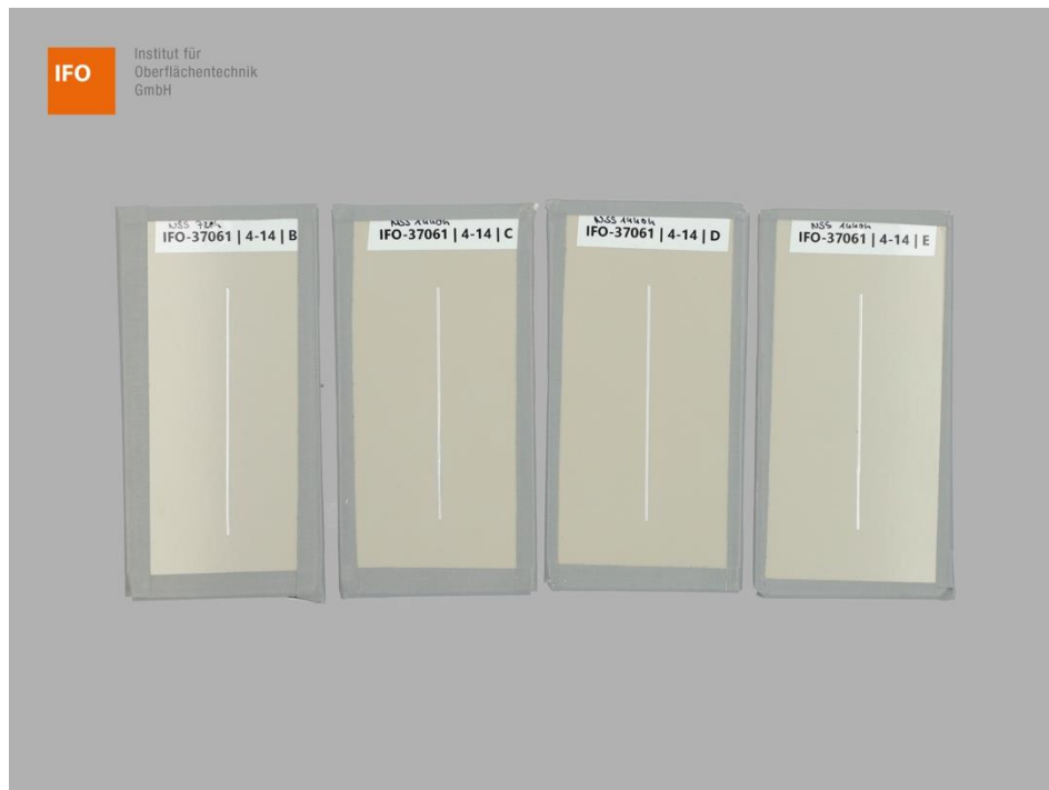
Abbildung 1 – Proben B, C, D und E der Gruppe 4 – Variante 14 vor der NSS-Prüfung
